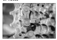
Vor allem bei Rädern mit Kettenschaltung ist immer auch die Kette auf Verschleiß zu kontrollieren. Den Verschleiß kann man mit einer speziellen Messlehre oder aber mit einer Schieblehre feststellen.
